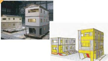
実際の振動台実験を PC 動画で再現
